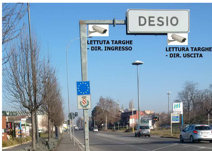
Foto 4 – Posizionamento apparati e direzioni di lettura
