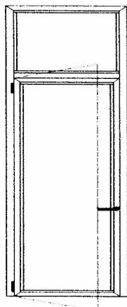
N.4 Porte Interne ad un'anta Battente con sopraluce fisso con vetro 44.2, da realizzare con profili in Alluminio in finitura Ossidato Naturale, telaio ad imbotte, maniglia, serratura con chiave. Pannello Abetspess. 40 mm finitura grigio chiaro argento.
