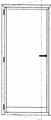
N.10 Porte Interne ad un'anta Battente, da realizzare con profili in Alluminio in finitura Ossidato Naturale, telaio ad imbotte, maniglia, dispositivo L/O. Pannello Abetspess. 40 mm finitura grigio chiaro argento
